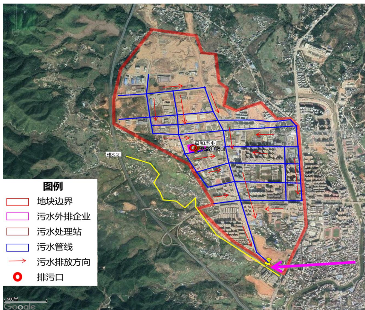
图 4.1-1 工业园污水管线图
